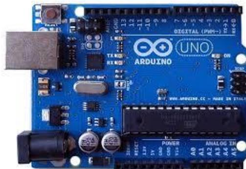
**Gambar 2.2.1 1Tampilan Depan Arduino Uno.**
