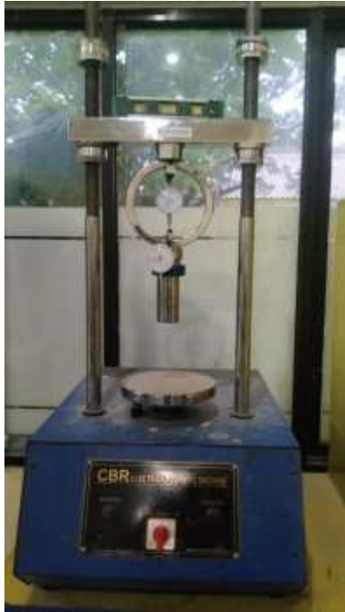
Alat uji penetrasi CBR
