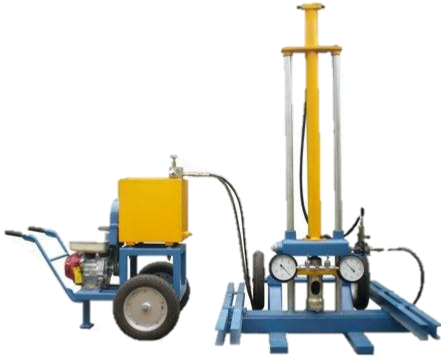
Gambar 3. 3 Alat Sondir Hidrolis
