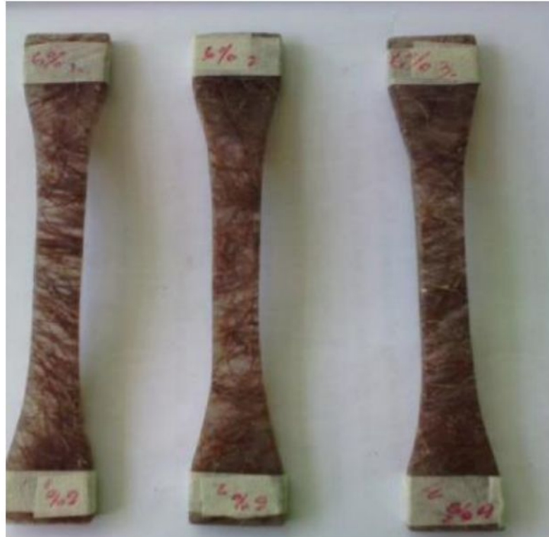
Gambar 4. 3 94% resin dan 6% serat gambas
