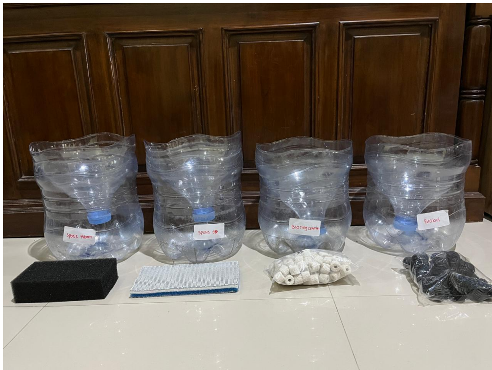
Gambar 4. Instalasi sederhana filtrasi air hujan
