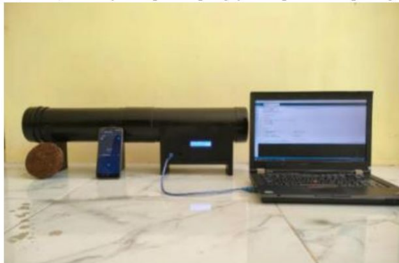
Gambar 4. 8 Alat Uji (Tabung Impedansi)
