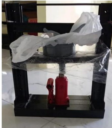
Gambar 4. 7 Proses pengepresan komposit dengan mesin pres hidrolis
