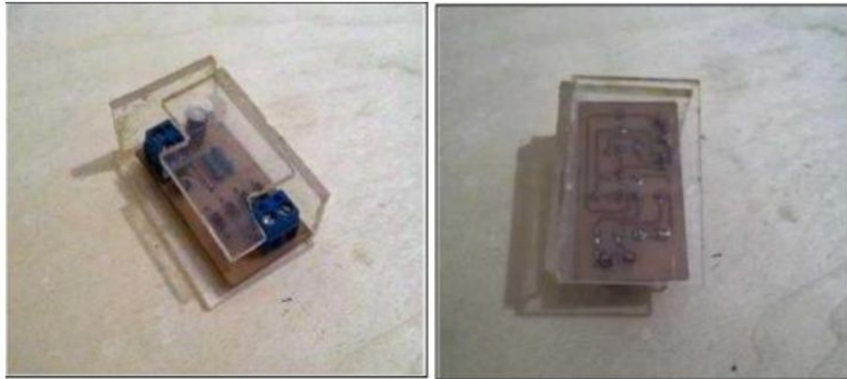
Gambar 2. 8 Tampak atas (kiri) dan bawah (kanan) rangkaian penyearah dan regulator (Akmal, 2017)
