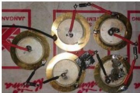
Gambar 4. 1 Pembuatan rangkaian seri pizoelektrik
