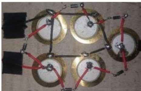
Gambar 4. 2 Pembuatan rangkaian paralel pizoelektrik
