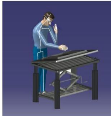
Gambar 4. 3 lingkungan virtual pengujian simulasi model manusia dengan konsep desain meja kerja pengelasan yang telah divalidasi.
