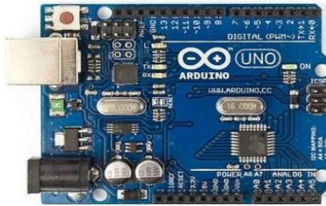
**Gambar 2.4 Arduino Mikrokontroler**
