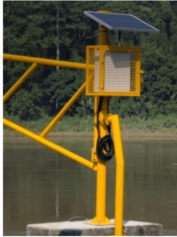
Gambar 4. 47 Sensor Pengukur Tinggi Muka Air
