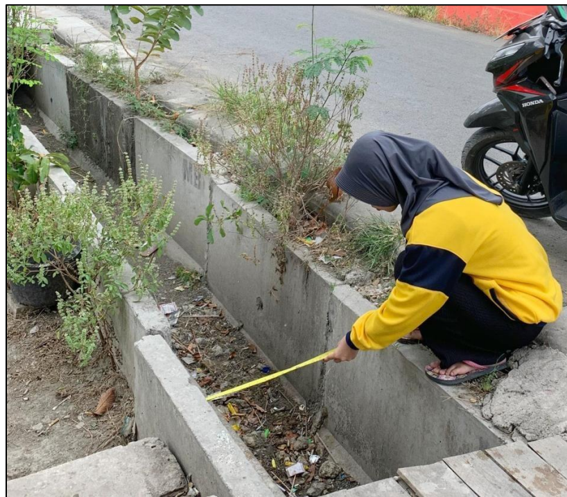
Gambar 3. 17 Survei Bangunan Eksisting Saluran Drainase Desa Butoh
