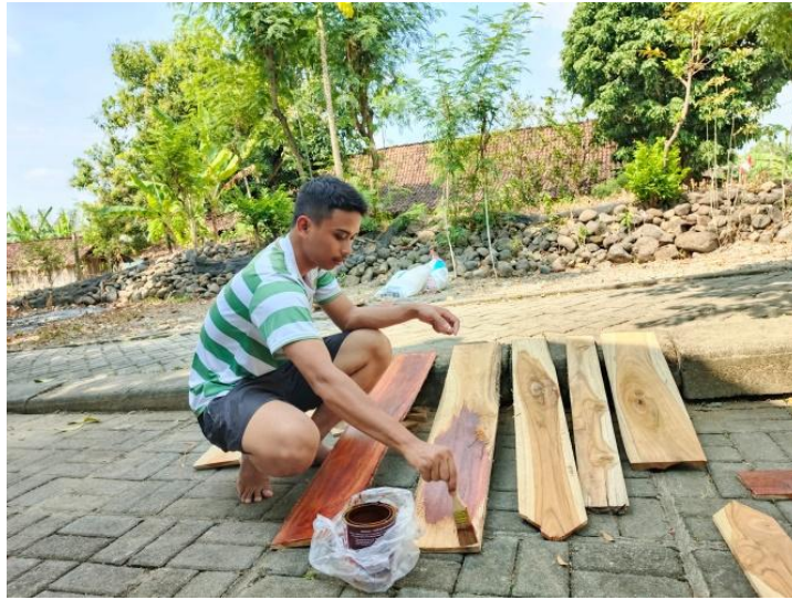
Gambar 3. 41 Pengecatan kayu dengan Plitur
