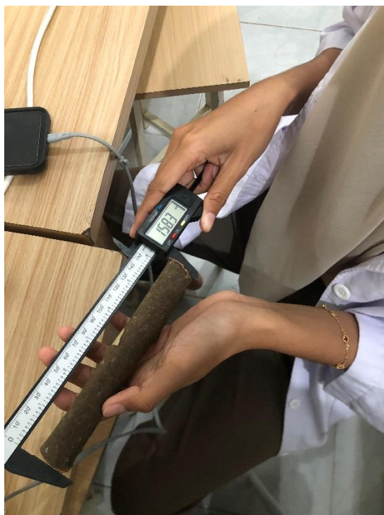
Gambar 3. 64 Sampel Ranting (Kering) Diukur Diameter dan Panjang Menggunakan Jangka Sorong
