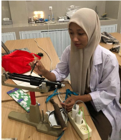
Gambar 3. 65 Sampel Ranting (Kering) di Timbang Menggunakan Timbangan Ohaus
