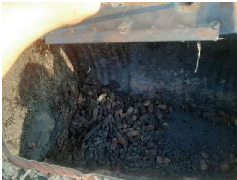
Gambar 2. Desain Kiln Karbonisasi Kapasitas 50 kg
