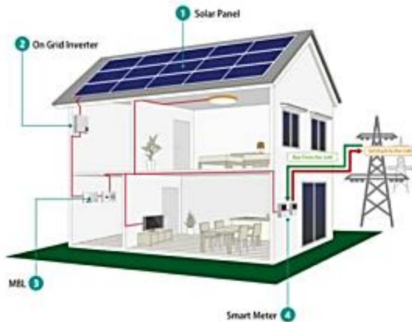
Gambar 2. 1 Cara kerja sel surya on-grif
