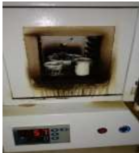
Pengarangan tongkol jagung dengan suhu 600°C selama 2 jam
