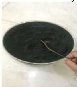
Pengayakan arang tongkol jagung menggunakan ayakan 100 mesh
