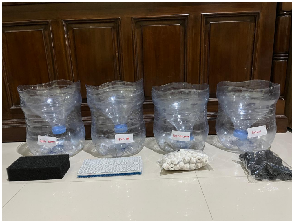
Gambar 4. Instalasi sederhana filtrasi air hujan
