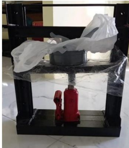
Gambar 4. 7 Proses pengepresan komposit dengan mesin pres hidrolik
