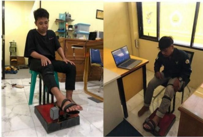
Gambar 4. 8 Proses Pengujian Eksoskeleton pada 7 subjek sehat dengan berat badan yang berbeda-beda
