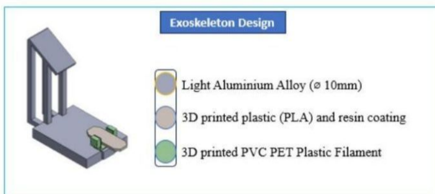
Gambar 4. 5 Komposisi material setiap part pada konsep desain exoskeleton
