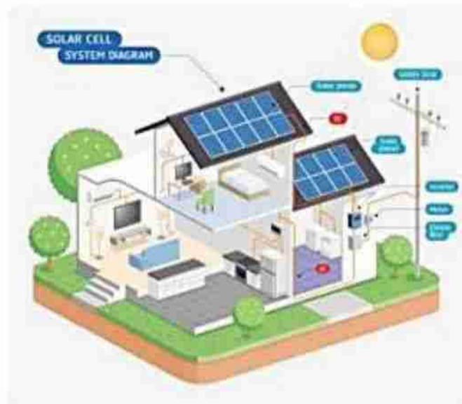
Gambar 2. 6 Visualisasi sistem distribusi PLTS tersebar
