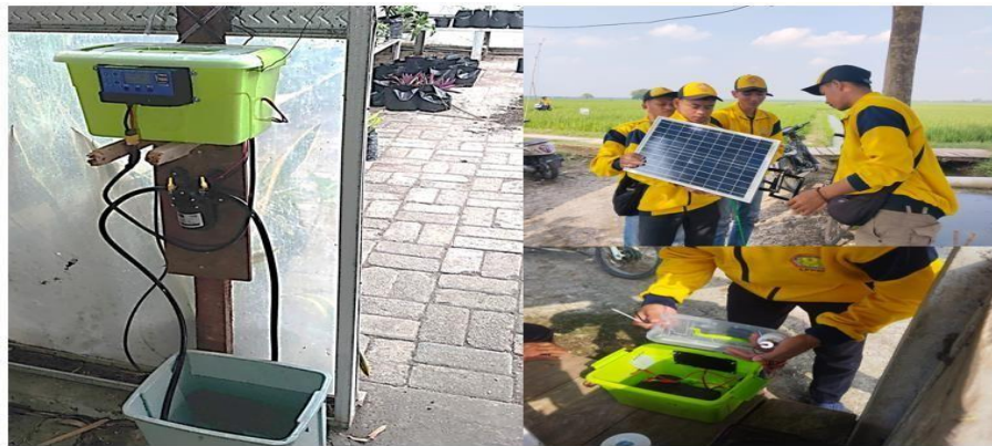
Gambar 5. 1 Proses pembuatan dan perakitannya alat penyiram tanaman otomatis dengan tenaga surya (solar panel).
